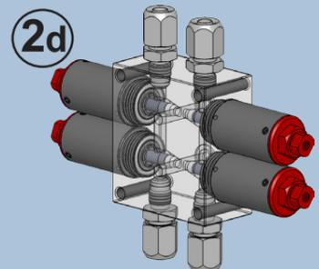
Zwischenblock mit Gewinde - mit Ringleitung
